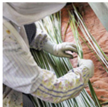
刈り取った七島藪は、選別されて分割機で2本に割く。七島藪そのままでは、太すぎて畳表にできないことと、2本に割くことでこの後の乾燥をし易くする。この分割作業で割かれた不整形な断面が七島藪の特長とも言える風合いを生み出す。
